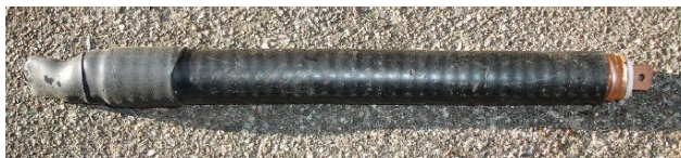
Fot. 1.2.9.2. Dławik składa się z 27 zwojów kabla koncentrycznego nawiniętego na rurce z PCW o średnicy ~11 cm
