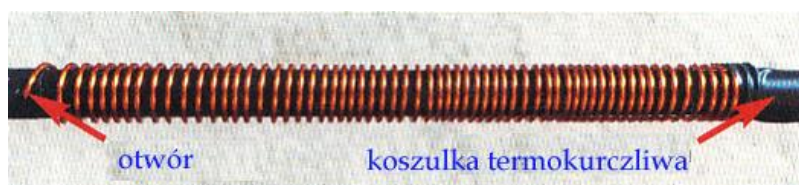
Rys. 1.2.2.2. Wykonanie cewki i doprowadzeń. Po lewej stronie widoczny otwór do wnętrza rury, a po lewej sposób zabezpieczenia za pomocą koszulki termokurczliwej
