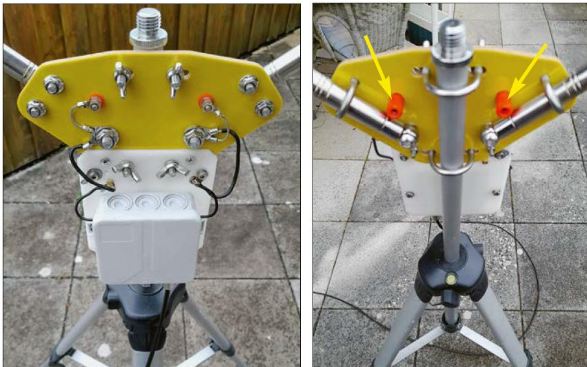
Fot.1.1.6.4. Płytkę montażową dla promiennika V. Transformator o przekładni 2:1 jest umieszczony w puszcze od instalacji elektrycznych widocznej poniżej. Do montażu na statywie służą obejm
