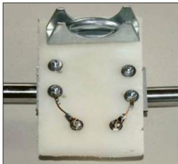
Fot. 1.1.6.1. Po lewej stronie kątowniki do montażu anten teleskopowych, po prawej widoczna obejma do zamocowania na maszcie
