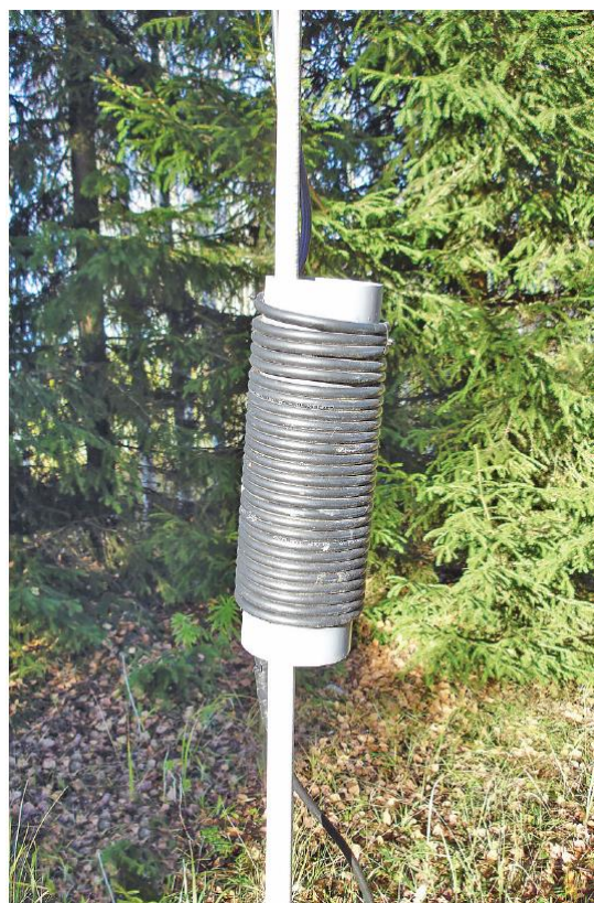
Fot. 1.2.9.4. Jako wzmocnienie połączeń służą plastikowe lubberki, do których wiązadłami są przywiązane końce kabli
