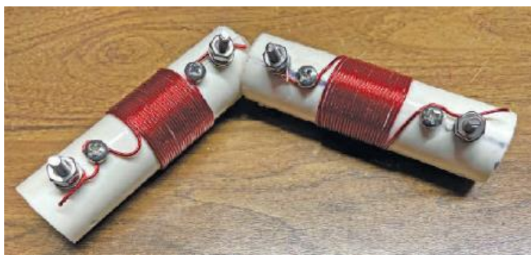
Fot. 1.2.7.3. Cewki przedłużające dla pasma 30 m przed ich zaimpregnowaniem i instalacją
