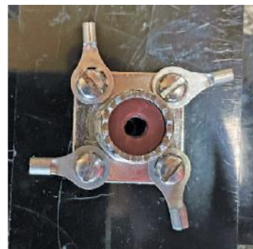
Fot. 1.2.7.3. Cewki przedłużające dla pasma 30 m przed ich zaimpregnowaniem i instalacją
